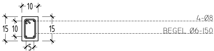
DETAIL RING BALOK KOLOM, 10x15cm
