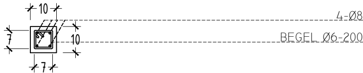
DETAIL KOLOM K2 KOLOM, 10x10cm
